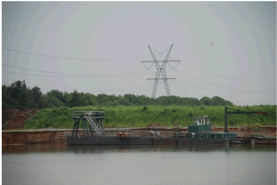
Figur 4.4: Suger, der anvendes til indvinding under grundvandsspejlet i de etablerede gravesøer.
