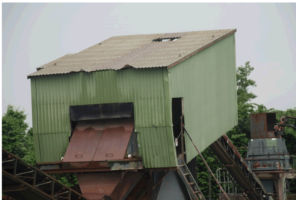
Figur 4.8: Støvafskærmning af sigte til fremstilling af stenmel.
