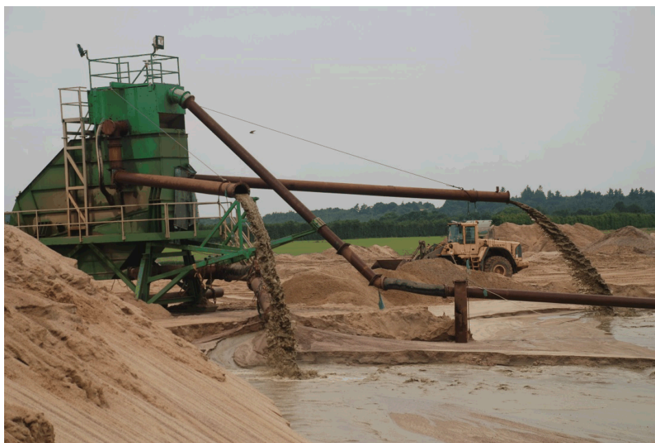
Figur 4.6: Afvander, der står ved bredden af de aktive gravesøer. Afvanderen sorterer det fine sand fra, som via rør sender det frasorterede sand direkte tilbage til kanten af søen, hvor det indgår i efterbehandlingen.
