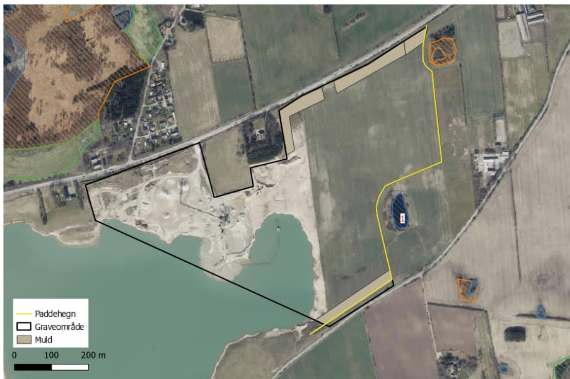
Figur 4-11: Placering af paddehegn og eksempel på placering af mulddepoter.
