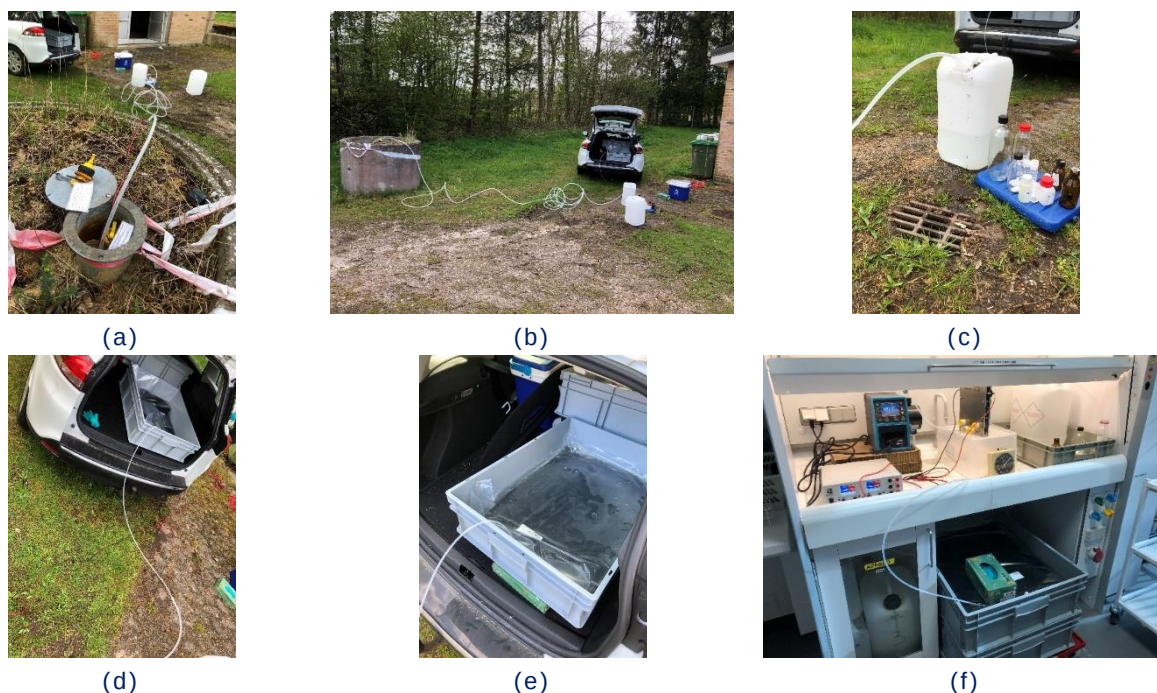
Figur 2: Fotos fra runde 2, 2. maj 2023, Grindsted. (a) og (b) Oppumpning af grundvand fra boring. (c) Vandprøvetagning i prøvebeholdere til ekstern analyse hos ALS Denmark A/S. (d) og (e) Oppumpning af grundvand fra boring til Tedlar pose. (f) Rensningsforsøg, med grundvandet fra Tedlar pose, i Aalborg Universitets laboratorier i Esbjerg.
