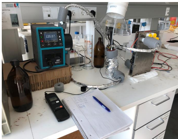
Figur 23: Foto af opstilling til måling af systemets varmeafgivelse. Recirkulation af 600 mL grundvand til reservoir, hvori vandets temperatur blev monitoreret. Som elektrodemateriale blev anvendt BDD.
