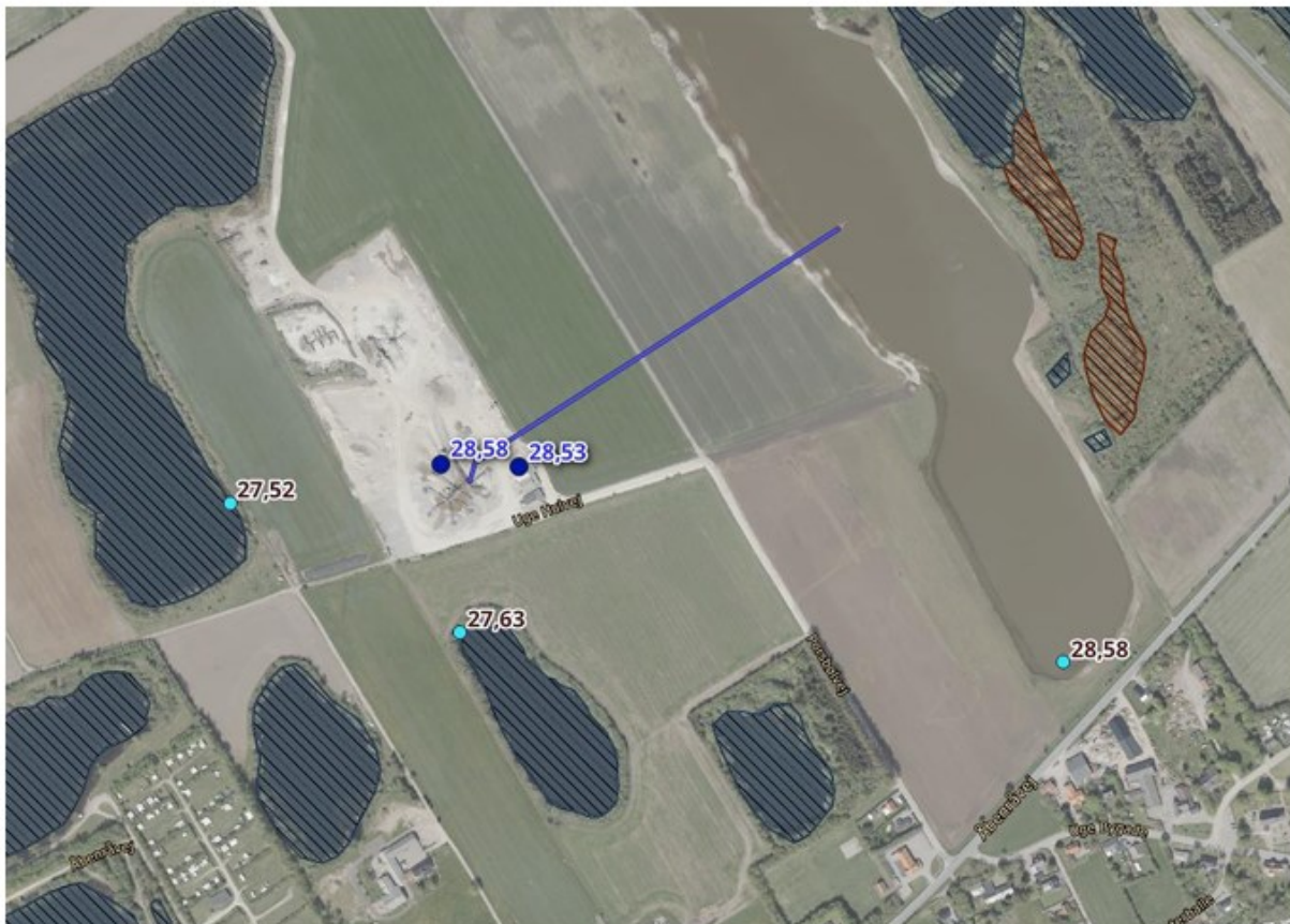
Figur 4 Vandspejlskoter målt i de to borer 11. februar 2025 (blå prikker) og i de tre søer målt 15. juli 2025 (turkis prikker).
