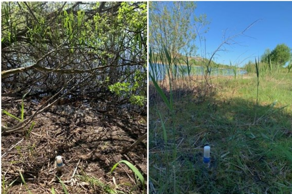
Figur 3 Pejlerør med dataloggere. Foto til venstre er fra den sydlige sø og foto til højre er fra den vestlige sø. Placering fremgår af Figur 2.
