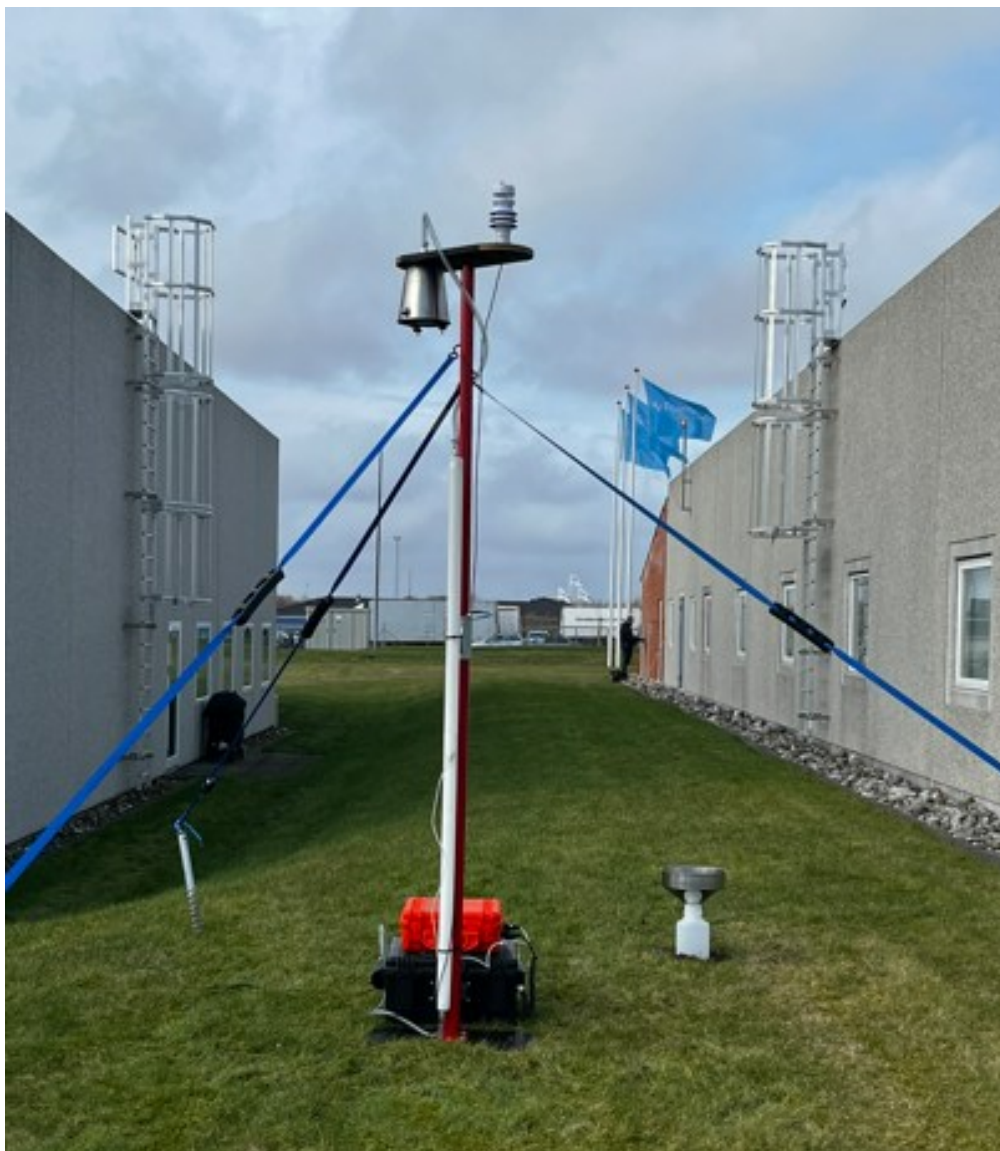
Figur 4.2: Opbygget prøvetager opstillet i forbindelse med test hos DMR i Nørresundby.
