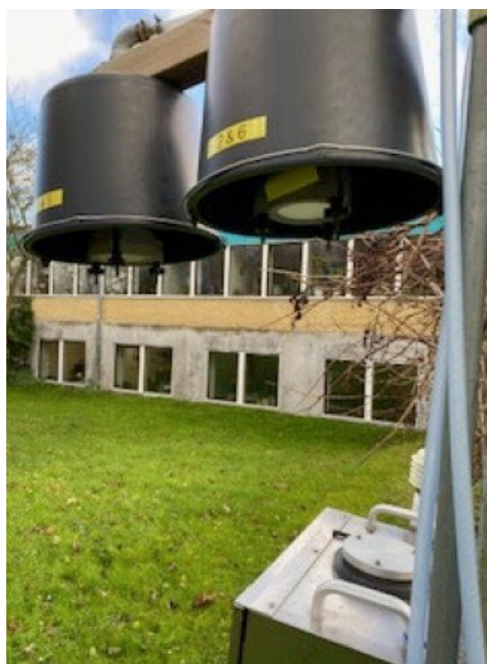
Figur 2.3: Prøvetager til aerosolprøvetagning anvendt i AU-DCE's projekt ved Risø. /4/
