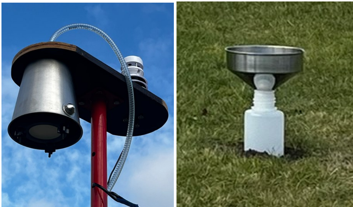
Figur 4.3: Til venstre: skærm over filterholder og filter. Til højre: opsamlingsflaske til nedbørsprøve og tragt.
