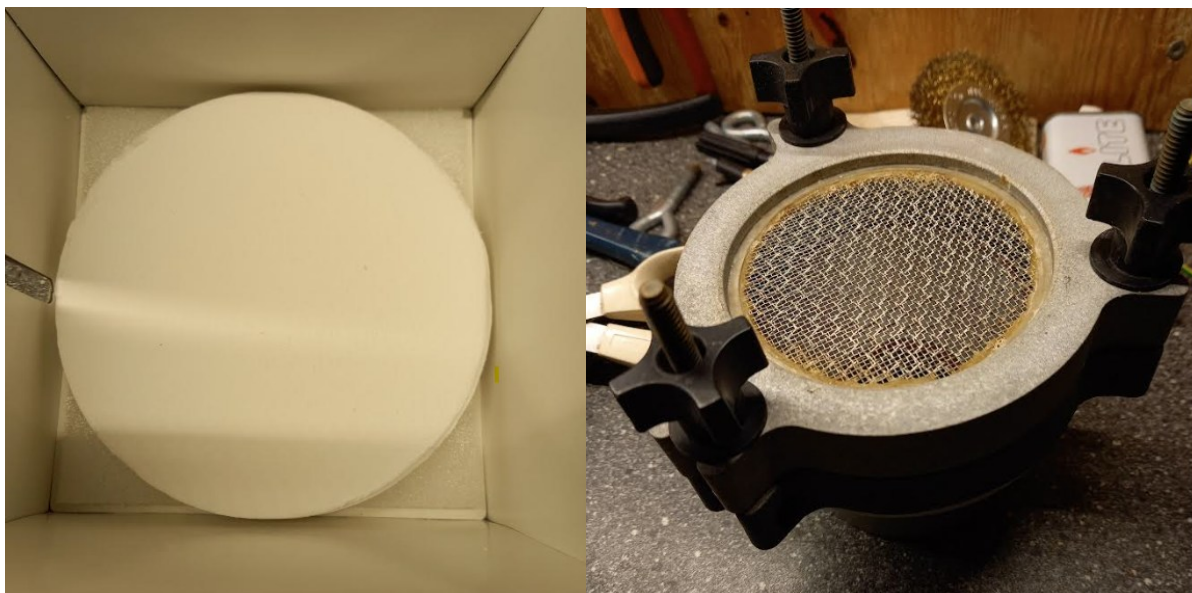
Figur 4.1: Til venstre: Kvartsfiberfilter til opsamling af aerosolprøve. Til højre: Filterholder til kvartsfiberfilter.
