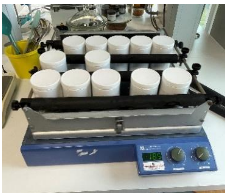
Figur 4 Fotos af udførelse af batchforsøg på rystebord og i temperaturstyret skab.
