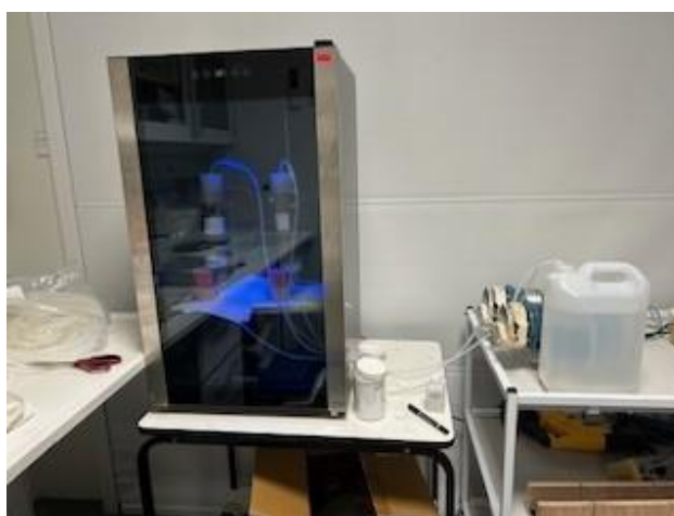
Figur 5 Foto af opstilling af kolonneforsøg.
