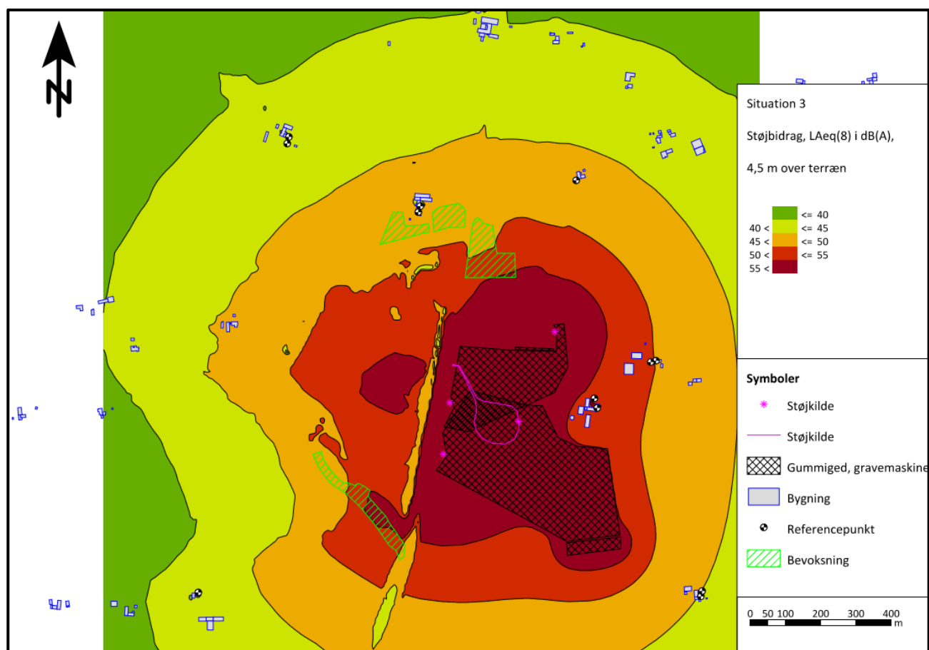
Figur 6: Situation 3. Beregnede støjbidrag, L_{Aeq(8)} i dB(A), 4,5 m over terræn, typisk svarende til 1. sals højde
