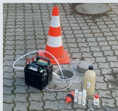
Figur 3C: Vandprøvetagning fra filtersat boring.
