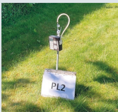
Figur 3B: Poreluftmåling udtaget i græsplæne.
