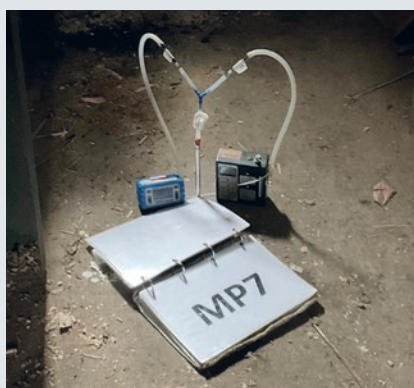
Figur 3A: Poreluftmåling udtaget indendørs igennem gulv.
