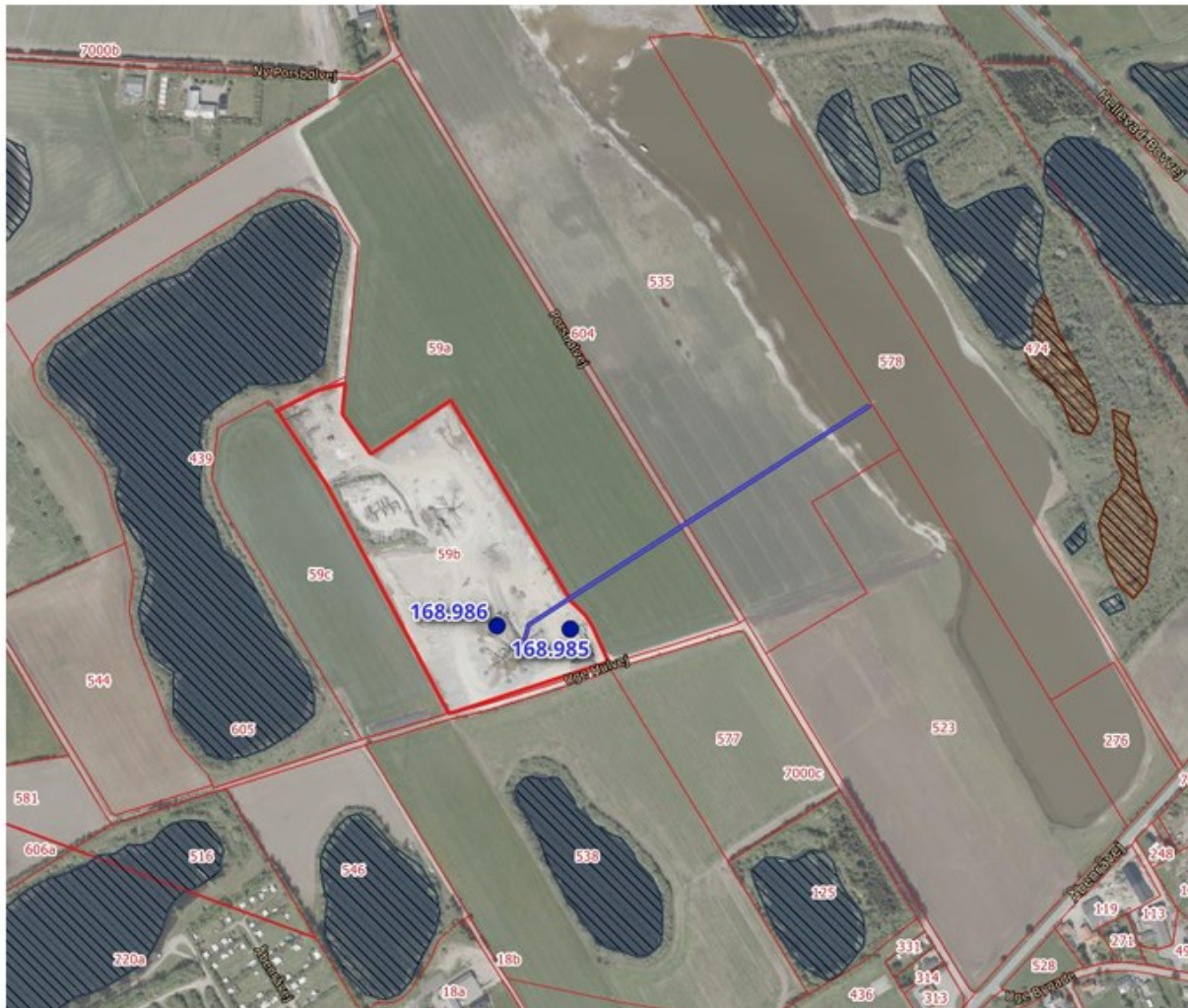
Figur 1 Oparbejdningsplads (59b), grusvaskboringer (blå prikker), udledning til gravesø (blå rørledning) samt § 3 beskyttede naturtyper (blå skravering=sø, rød skravering=mose).
