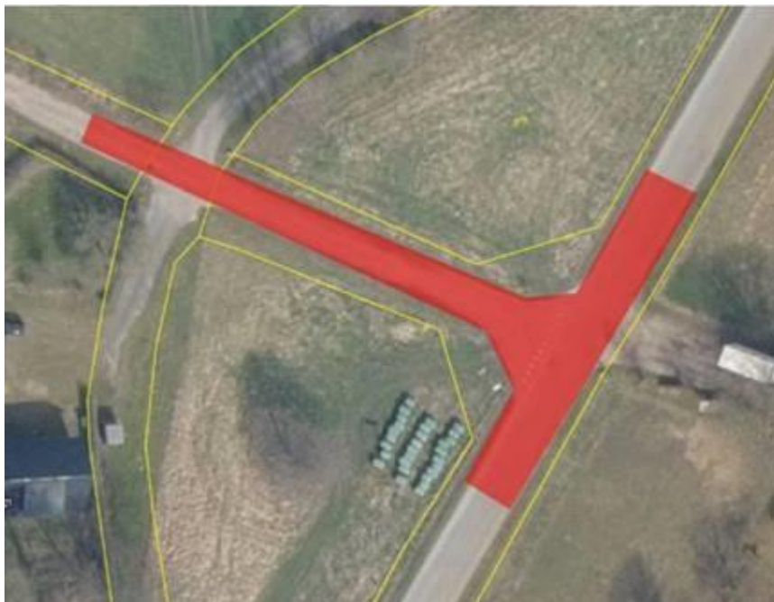
Areal hvor belægningen skal forstærkes.
