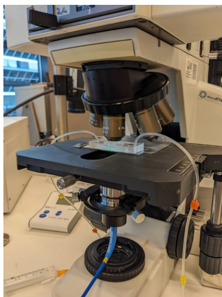
Figur 1: Venstre: Test setup til CPHNano's FK med optisk mikroskop, lyskilde og fiber til spektrometer (ikke vist). Højre: Eksempel på data fra 2 spektrometre (Shimadzu og Maya) der viser sammenhæng mellem brydningsindeks (RI) og koncentration af saltvandsopløsning (% NaCl).
