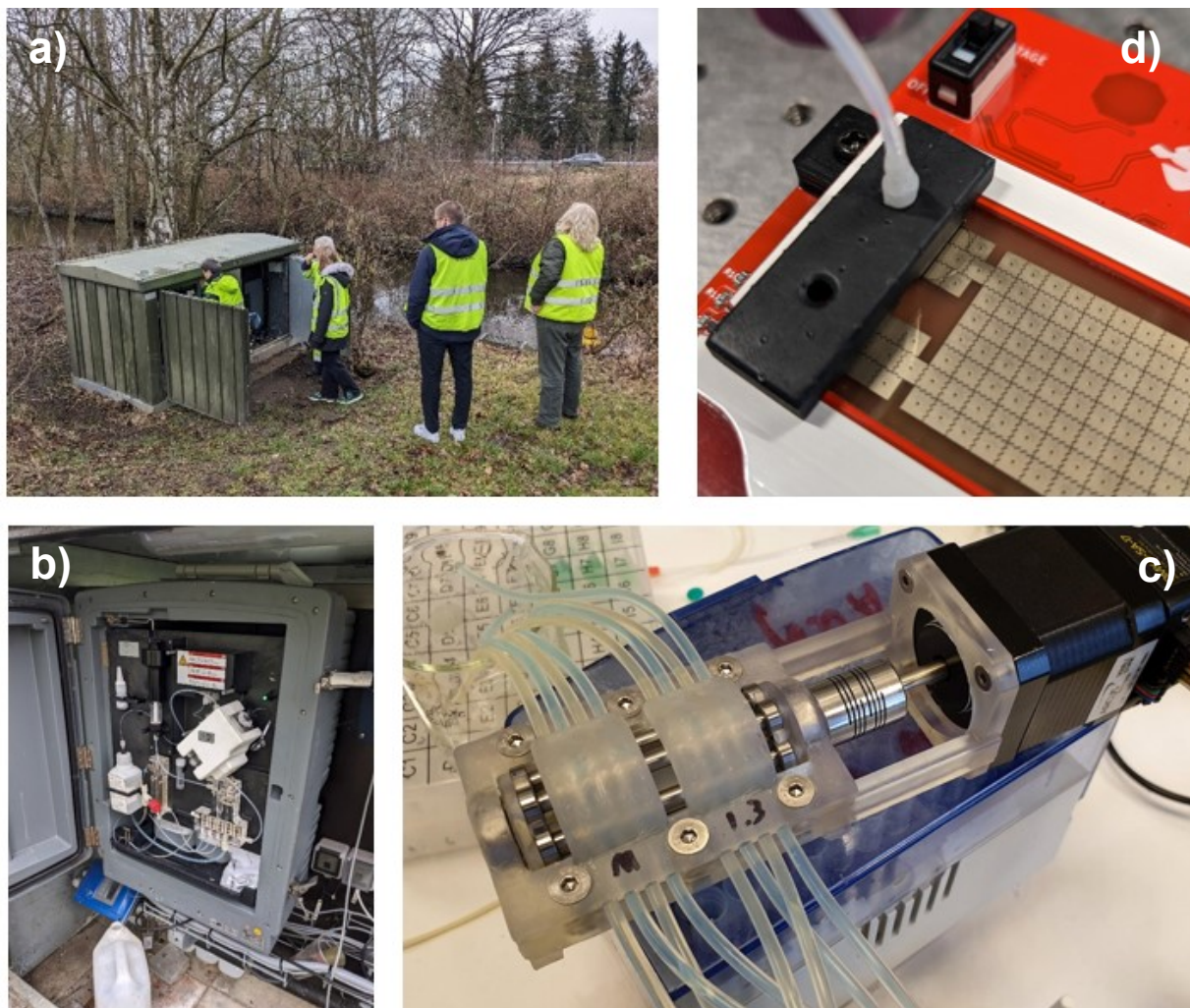
Figur 2. Besøg ved Nordvest rensningsanlæg ved Odense Å sammen med VandCenter Syd, a) pumpestation og b) medhørende måleskab, c) Open-Source peristaltisk pumpe baseret på FAST, brugt til test af vandopsamling og d) Prøvedeponering på printkort-elektroder direkte fra pumpen.
