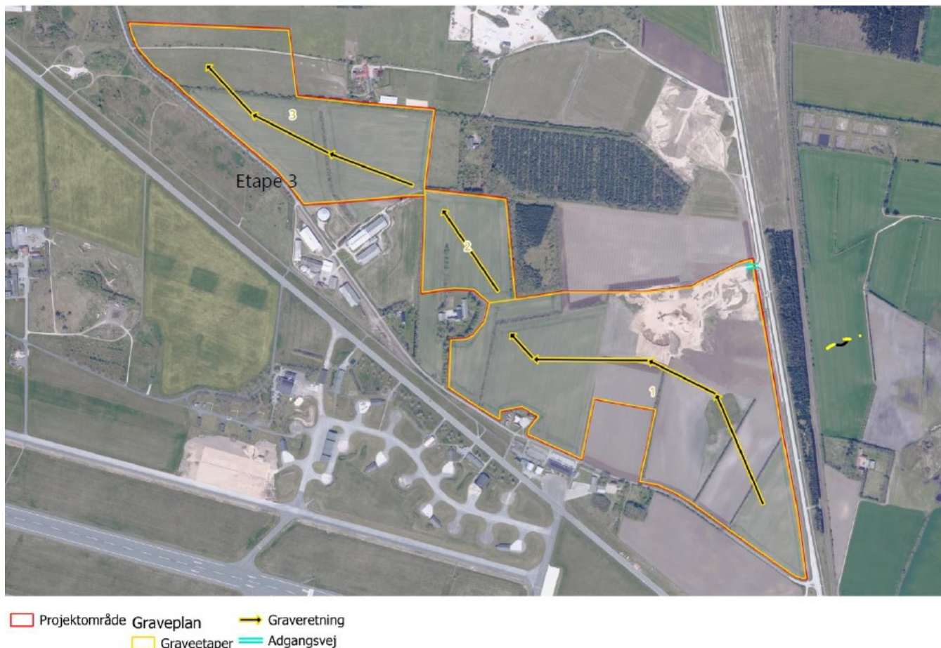
Figur 2.1 projektområdet med adgangsvej, graveretning og etaper markeret. Figuren er taget fra den indsendte grave- og efterbehandlingsplan.
