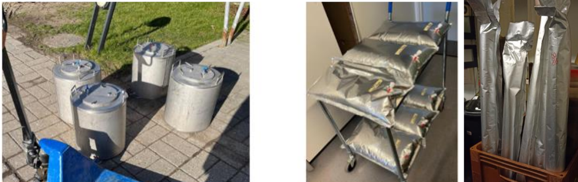
Figur 3.2. Venstre) Ståltankene anvendt til grundvandsprøvetagning; midt) Tedlarposerne hvortil grundvand blev overført, og som fungerede som indløb til kolonneforsøgene; højre) forseglende kerneprøver med sediment.
