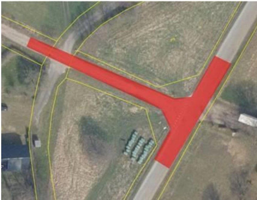
Areal hvor belægningen skal forstærkes.
