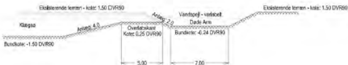
Figur 3-5 Tværsnit mellem klægsøen og Brede Å's Døde Arm, hvor der etableres en forbindelse ved høj vandstand i Brede Å.
