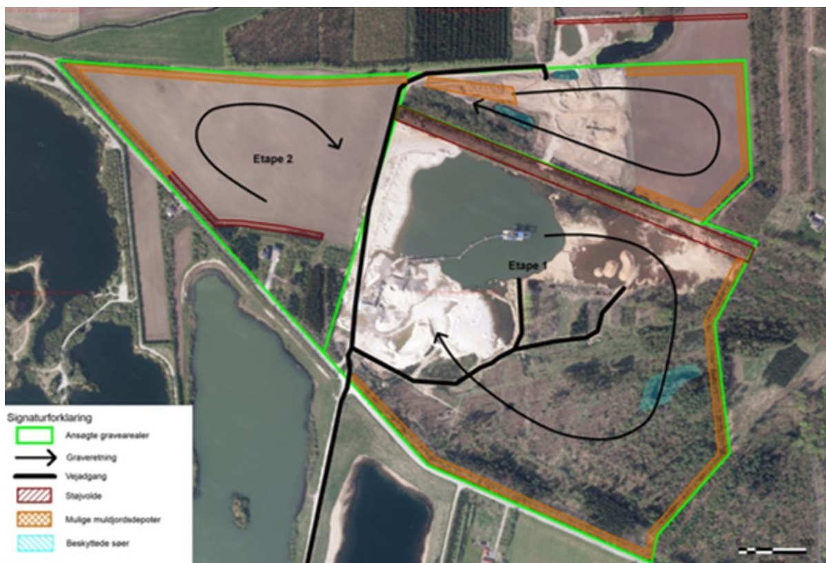
Figur 10 Graveetaper/faser for det ansøgte råstofprojekt (projekt 3). Den nordlige del af graveområdet på kortet er afsluttet og der ansøges derfor ikke om forlængelse på dette stykke. Derimod ansøges der om at afslutte etape/fase 1 og herefter indvinde etape/fase 2.
